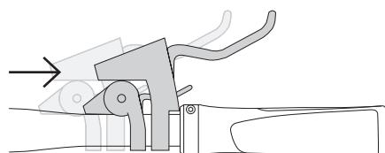
シフター、ブレーキレバーを適切な位置に移動し、クランプボルトを締めて固定します。
