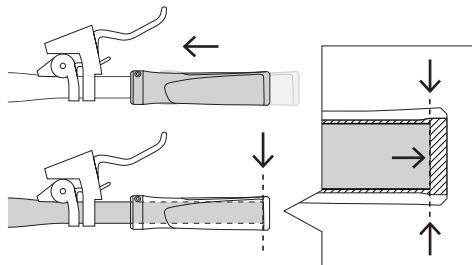
グリップの左右を確認します。グリップのクランプ ポルトを 3mm 六角レンチを使用して、反時計回りに 3~4 回転させて緩めます。
