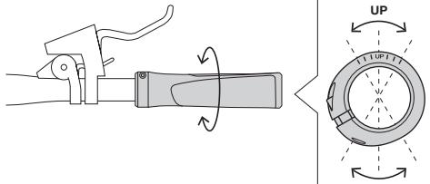
クランプ側面の UP マークがハンドルバーの直上になる角度を基準に、好みの角度にグリップを調整します。
