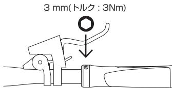
トルクレンチを使用してクランプボルトを締めます。
